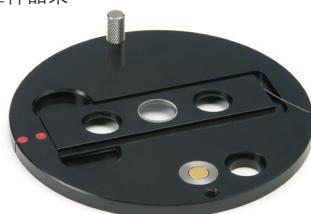
ValPro 显微性能验证附件：可进行透射，反射和ATR检测方式验证
